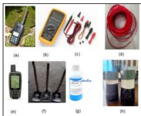
Gambar 2. Alat dan bahan (a) Handy Talky (HT), (b) Multimeter Digital , (c) capit buaya , (d) kabel roll , (e) Global Positioning System (GPS), (f) Sekop/cangkul , dan (g) Larutan CuSO 4 .
